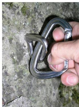
dies nicht, hat der Mörtel gut abgebunden und dem Haken kann vertraut werden. Lässt sich der Haken mit dem Karabiner als Hebel lösen, ist der Mörtelverbund unzureichend (vgl. Abbildung).
