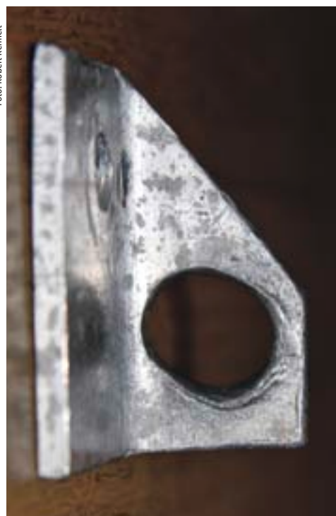
Selbst gefertigte Aluminiumlasche. Die Öse zeigt deutliche Verschleisserscheinungen, wodurch das Material im Randbereich gefährlich dünn geworden ist.
