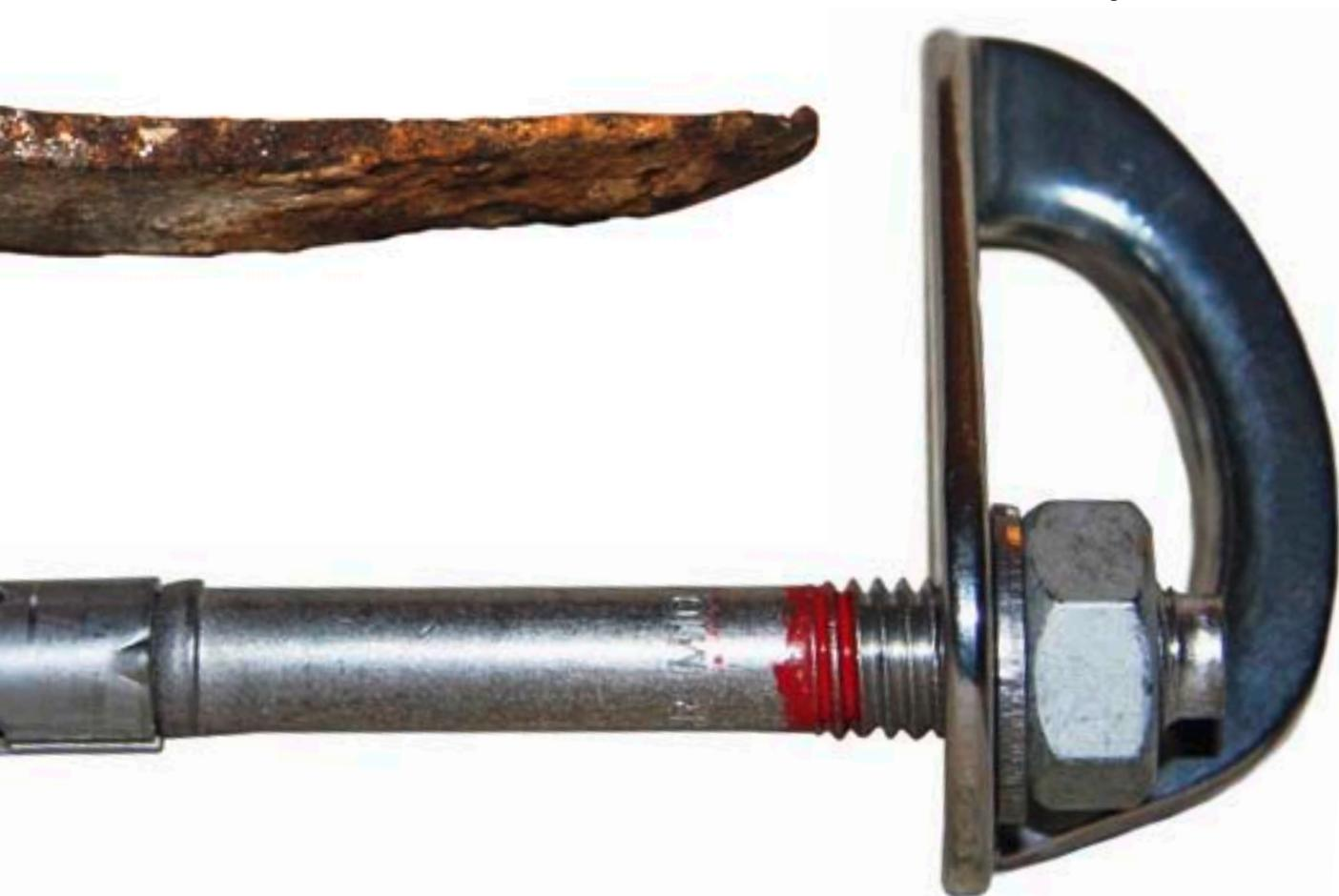
**(Schlag-)Haken werden in natürliche Risse, Ritzen und Löcher gesetzt. Die Länge und die Klemmwirkung des im Fels steckenden Hakenschaftes sowie die Korrosion sind nicht sichtbar. Entsprechend problematisch ist die Haltekraft einzuschätzen.**
