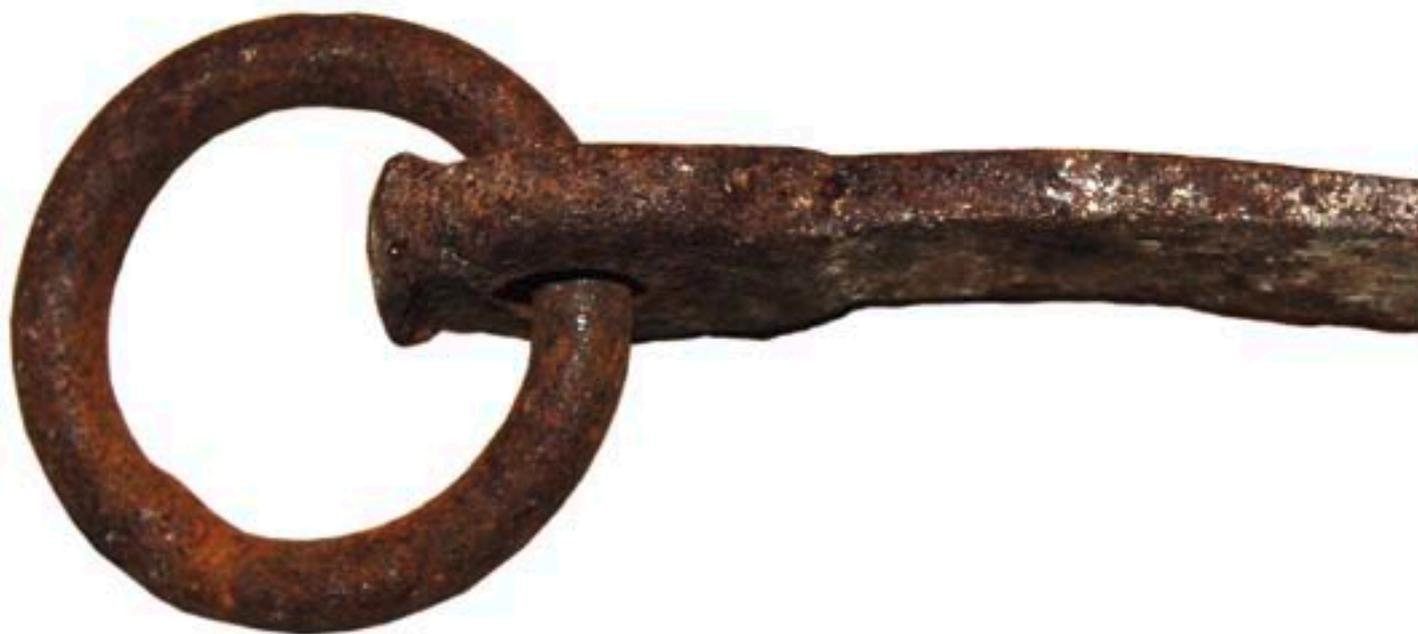
**Selbst gefertigter Schlaghaken:** Seine Haltekraft ist nicht einzuschätzen. Je nach Korrosion und dem Verlauf des Risses, in den er geschlagen wurde, verfügt ein solcher Haken noch über eine gewisse Haltekraft, oder aber er kann praktisch von Hand herausgezogen werden.
