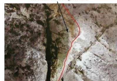
zu geringer Abstand zum Riss Haken ist durch die Belastung bei einem Sturz ausgebrochen schwachstellen im Fels
